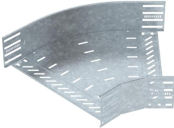
Coude à 45° pour créer une dérivation horizontale, pièce de forme pour chemins de câbles encliquetables et vissables d'une hauteur d'aile de 110 mm. Montage sans vis avec bornes doubles ou raccord vissé avec vis à tête bombée FRS et écrous à rondelle sertie M6. Utilisable en intérieur et en extérieur. Le matériel de fixation doit être commandé séparément.
