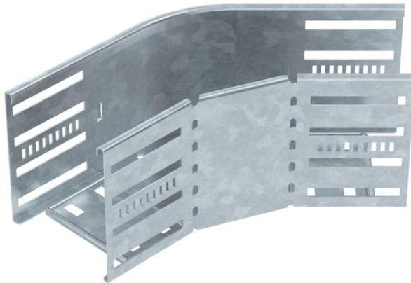
45°-Bogen zum Erstellen einer horizontalen Abzweigung, Formteil für rast- und schraubbare Kabelrinnen Seitenhöhe 110 mm. Schraubenlose Montage mit Doppelklemmen oder Schraubverbindung mit Flachrundschrauben FRS und Kombimuttern M6. Einsetzbar im Innen- und Außenbereich. Befestigungsmaterial muss separat bestellt werden.
