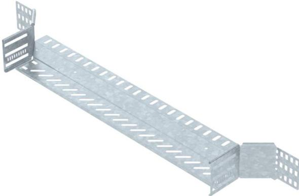
Anbau-Abzweigstück zum Erstellen einer horizontalen Abzweigung oder Kreuzung, Formteil für rast- und schraubbare Kabelrinnen Seitenhöhe 85 mm. Schraubenlose Montage mit Doppelklemmen oder Schraubverbindung mit Flachrundschrauben FRS und Kombimuttern M6. Einsetzbar im Innen- und Außenbereich. Befestigungsmaterial muss separat bestellt werden.
