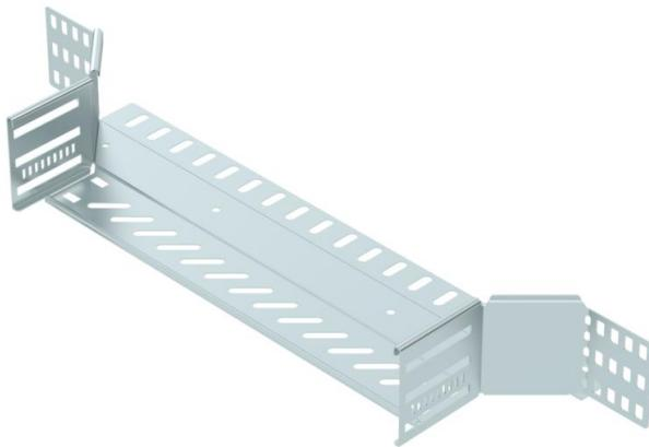
Anbau-Abzweigstück zum Erstellen einer horizontalen Abzweigung oder Kreuzung, Formteil für rast- und schraubbare Kabelrinnen Seitenhöhe 85 mm. Schraubenlose Montage mit Doppelklemmen oder Schraubverbindung mit Flachrundschrauben FRS und Kombimuttern M6. Einsetzbar im Innenbereich. Befestigungsmaterial muss separat bestellt werden.
