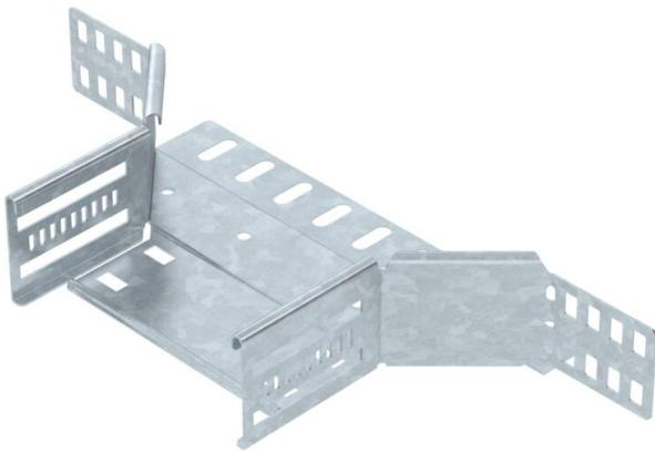
Anbau-Abzweigstück zum Erstellen einer horizontalen Abzweigung oder Kreuzung, Formteil für rast- und schraubbare Kabelrinnen Seitenhöhe 60 mm. Schraubenlose Montage mit Doppelklemmen oder Schraubverbindung mit Flachrundschrauben FRS und Kombimuttern M6. Einsetzbar im Innen- und Außenbereich. Befestigungsmaterial muss separat bestellt werden.
