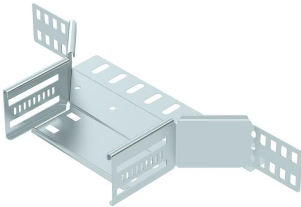
Anbau-Abzweigstück zum Erstellen einer horizontalen Abzweigung oder Kreuzung, Formteil für rast- und schraubbare Kabelrinnen Seitenhöhe 60 mm. Schraubenlose Montage mit Doppelklemmen oder Schraubverbindung mit Flachrundschrauben FRS und Kombimuttern M6. Einsetzbar im Innenbereich. Befestigungsmaterial muss separat bestellt werden.
