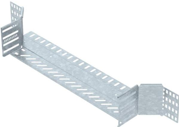
Dérivation à monter pour créer une dérivation horizontale ou une croix, pièce de forme pour chemins de câbles encliquetables et vissables d'une hauteur d'aile de 110 mm. Montage sans vis avec bornes doubles ou raccord vissé avec vis à tête bombée FRS et écrous à rondelle sertie M6. Utilisable en intérieur et en extérieur. Le matériel de fixation doit être commandé séparément.
