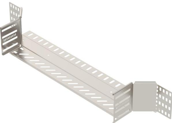
Anbau-Abzweigstück zum Erstellen einer horizontalen Abzweigung oder Kreuzung, Formteil für rast- und schraubbare Kabelrinnen Seitenhöhe 110 mm. Schraubenlose Montage mit Doppelklemmen oder Schraubverbindung mit Flachrundschrauben FRS und Kombimuttern M6. Einsetzbar im Innen- und Außenbereich. Befestigungsmaterial muss separat bestellt werden.
