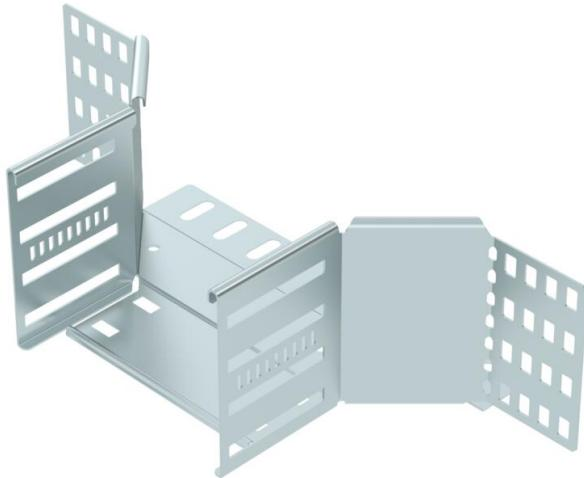
Anbau-Abzweigstück zum Erstellen einer horizontalen Abzweigung oder Kreuzung, Formteil für rast- und schraubbare Kabelrinnen Seitenhöhe 110 mm. Schraubenlose Montage mit Doppelklemmen oder Schraubverbindung mit Flachrundschrauben FRS und Kombimuttern M6. Einsetzbar im Innenbereich. Befestigungsmaterial muss separat bestellt werden.
