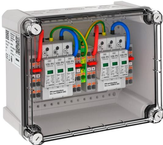
Generatoranschlusskasten Typ 2 für Photovoltaikanlagen zum Anschluss von 2 x 2 Strings. Zum DC-Schutz des Wechselrichters.
