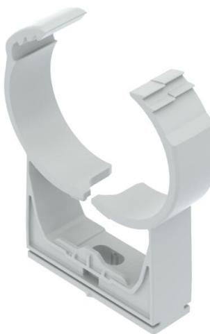
Hochbelastbare Schelle zur Aufnahme von Elektro- und Sanitärrohren aus Kunststoff und Metall sowie Elektroinstallationsrohr Quick-Pipe. Universelle Befestigungsmöglichkeiten an Wand, Decke und Stahlkonstruktionen im Innen- und Außenbereich. Flexibler Spannbereich von mehreren Millimetern. Werkzeuglose Rohrmontage. Aneinander reihbar bis Ø 32 mm, auch mit OBO Quick- oder Multi-Quick-Schelle. Für variable Abstände und Schellenanzahl montierbar auf Profilschiene.
