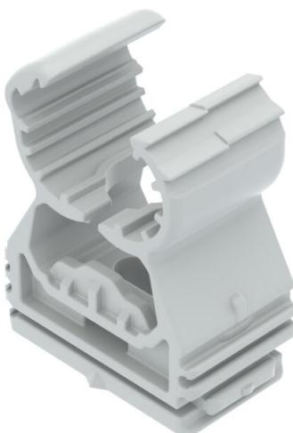
Hochbelastbare Schelle zur Aufnahme von Elektro- und Sanitärrohren aus Kunststoff und Metall sowie Elektroinstallationsrohr Quick-Pipe. Universelle Befestigungsmöglichkeiten an Wand, Decke und Stahlkonstruktionen im Innen- und Außenbereich. Flexibler Spannbereich von mehreren Millimetern. Werkzeuglose Rohrmontage. Aneinander reihbar bis Ø 28 mm, auch mit OBO Quick- oder star-Quick-Schelle. Für variable Abstände und Schellenanzahl montierbar auf Profilschiene.
