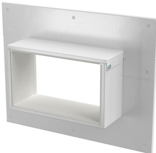
Wandanschlusskragen, 4-seitig mit integrierter Dichtung für Installationskanal PYROLINE® Rapid PLM. Zur Montage im Bereich von Wand- und Deckenanschlüssen sowie Wanddurchführungen. Auch als 3-seitiger Wandanschlusskragen bei direkter Wand- oder Deckenmontage des Kanals einsetzbar. Kein elektrischer Funktionserhalt nach DIN 4102 Teil 12!
