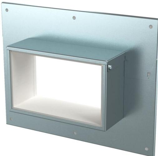
Collare di collegamento a parete, a 4 lati con guarnizione integrata per condotto di installazione PYROLINE® Rapid PLM. Per il montaggio nella zona di connessioni a parete e a soffitto, nonché di canalizzazioni a parete. Utilizzabile anche come collare di collegamento a parete a 3 lati per il montaggio diretto a parete o a soffitto del condotto.
