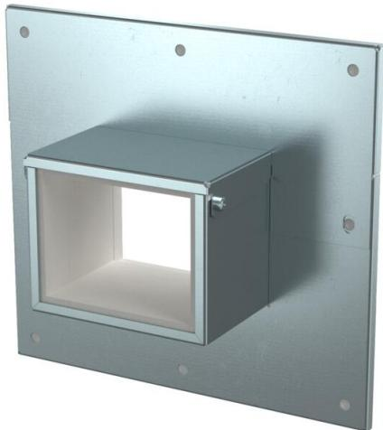
Collare di collegamento a parete, a 4 lati con guarnizione integrata per condotto di installazione PYROLINE® Rapid PLM. Per il montaggio nella zona di connessioni a parete e a soffitto, nonché di canalizzazioni a parete. Utilizzabile anche come collare di collegamento a parete a 3 lati per il montaggio diretto a parete o a soffitto del condotto.
