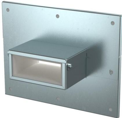
Collare di collegamento a parete, a 4 lati con guarnizione integrata per condotto di installazione PYROLINE® Rapid PLM. Per il montaggio nella zona di connessioni a parete e a soffitto, nonché di canalizzazioni a parete. Utilizzabile anche come collare di collegamento a parete a 3 lati per il montaggio diretto a parete o a soffitto del condotto.
