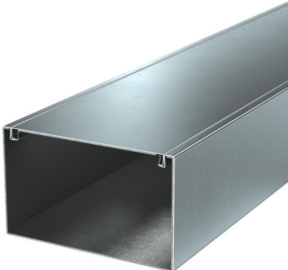
Condotto di installazione in metallo con tessuto antincendio intumescente per la posa ignifuga dei cavi. Classificato come condotto di installazione EI30, EI60 e EI90 a norma EN 13501-2, testato a norma EN 1366-5. Il condotto impedisce, nell'intervallo classificato, la propagazione dell'incendio e protegge dalle conseguenze dell'incendio dei cavi.
