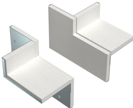
Collare di collegamento a parete, bilaterale con guarnizione integrata per condotto di installazione PYROLINE® Rapid PLM. Per il montaggio nella zona di connessioni a parete e a soffitto, nonché di canalizzazioni a parete negli angoli dell'ambiente. Set costituito da 2 componenti opposti, adatto per il montaggio a soffitto o a parete del condotto di installazione.
