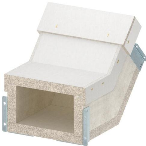
Curva verticale in salita per canale antincendio PYROLINE® Con S EI60, tipo PLCS D061220 in calcestruzzo leggero con fibra di vetro resistente all'acqua e al gelo per realizzare variazioni di direzione verticali (45°) nello sviluppo del canale. I materiali di collegamento montati consentono un rapido montaggio dei pezzi del canale sul posto, i coperchi allentati consentono una rapida revisione e disposizione successiva.
