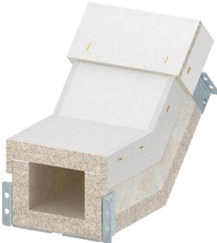
Curva verticale in salita per canale antincendio PYROLINE® Con S EI60, tipo PLCS D060810 in calcestruzzo leggero con fibra di vetro resistente all'acqua e al gelo per realizzare variazioni di direzione verticali (45°) nello sviluppo del canale. I materiali di collegamento montati consentono un rapido montaggio dei pezzi del canale sul posto, i coperchi allentati consentono una rapida revisione e disposizione successiva.
