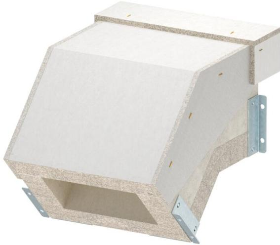
Curva verticale discendente per canale antincendio PYROLINE® Con S EI90, tipo PLCS D091220 in calcestruzzo leggero con fibra di vetro resistente all'acqua e al gelo per realizzare variazioni di direzione verticali (45°) nello sviluppo del canale. I materiali di collegamento montati consentono un rapido montaggio dei pezzi del canale sul posto, i coperchi allentati consentono una rapida revisione e disposizione successiva.
