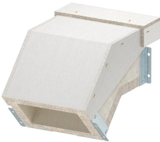
Curva verticale discendente per canale antincendio PYROLINE® Con S EI60, tipo PLCS D061220 in calcestruzzo leggero con fibra di vetro resistente all'acqua e al gelo per realizzare variazioni di direzione verticali (45°) nello sviluppo del canale. I materiali di collegamento montati consentono un rapido montaggio dei pezzi del canale sul posto, i coperchi allentati consentono una rapida revisione e disposizione successiva.
