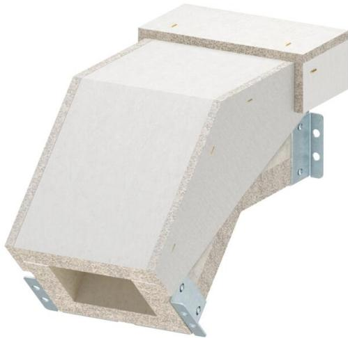
Curva verticale discendente per canale antincendio PYROLINE® Con S EI60, tipo PLCS D060810 in calcestruzzo leggero con fibra di vetro resistente all'acqua e al gelo per realizzare variazioni di direzione verticali (45°) nello sviluppo del canale. I materiali di collegamento montati consentono un rapido montaggio dei pezzi del canale sul posto, i coperchi allentati consentono una rapida revisione e disposizione successiva.
