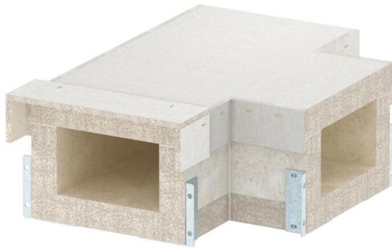
Raccordo a T per canale antincendio PYROLINE® Con S EI90, tipo PLCS D091220 in calcestruzzo leggero con fibra di vetro resistente all'acqua e al gelo per realizzare derivazioni a T nello sviluppo del canale. I materiali di collegamento montati consentono un rapido montaggio dei pezzi del canale sul posto, i co- perchi allentati consentono una rapida revisione e disposizione successiva.
