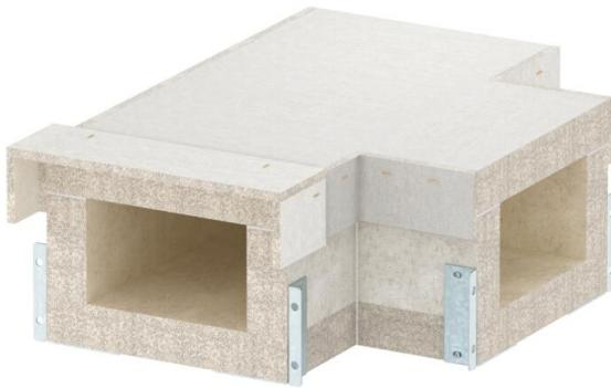
T-Stück für Brandschutzkanal PYROLINE® Con S EI90, Typ PLCS D091220 bestehend aus wasser- und frostbeständigem Glasfaserleichtbeton zur Herstellung von T-Abzweigungen im Kanalverlauf. Fertig montierte Verbindungsbeschläge sorgen für eine schnelle Montage vor Ort, lose aufgelegte Deckel für eine schnelle Revision und Nachbelegung.
