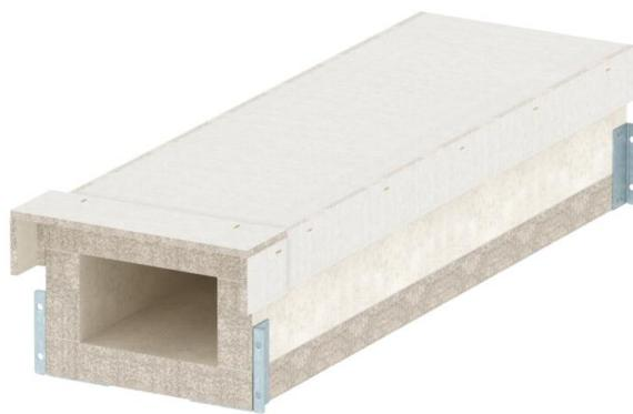
Canale antincendio in calcestruzzo leggero con fibra di vetro resistente all'acqua e al gelo della classe materiali A1 secondo la EN 13501-1 per la posa a prova d'incendio di cavi in vie di fuga e di soccorso. Classificazione EI90 come canale di installazione secondo la EN 13501-2 sulla base di prove secondo la EN 1366-5. In caso di carico di incendio dall'interno (incendio di cavi), il canale ne impedisce la propagazione da una compartimentazione all'altra.
