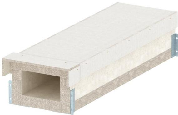
Goulotte coupe-feu composée de béton allégé armé de fibres de verre résistant à l'humidité et au gel de la classe A1 selon EN 13501-1 relative à la pose coupe-feu de câbles dans des voies d'évacuation et issues de secours. Classification EI90 comme goulotte d'installation conformément à la norme EN 13501-2 sur la base des essais conformément à la norme EN 1366-5 En cas de charge combustible à l'intérieur (feu de câble), la goulotte empêche la propagation du feu à une autre section par le câble.
