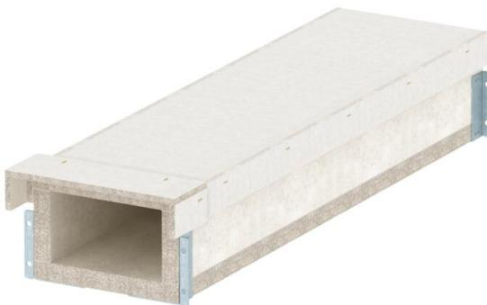
Canale antincendio in calcestruzzo leggero con fibra di vetro resistente all'acqua e al gelo della classe materiali A1 secondo la EN 13501-1 per la posa a prova d'incendio di cavi in vie di fuga e di soccorso. Classificazione EI30 - EI60 come canale di installazione secondo la EN 13501-2 sulla base di prove secondo la EN 1366-5. In caso di carico di incendio dall'interno (incendio di cavi), il canale ne impedisce la propagazione da una compartimentazione all'altra.
