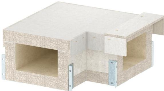
Curva a 90° per canale antincendio PYROLINE® Con S EI90, tipo PLCS D091220 in calcestruzzo leggero con fibra di vetro resistente all'acqua e al gelo per realizzare variazioni di direzione orizzontali nello sviluppo del canale. I materiali di collegamento montati consentono un rapido montaggio dei pezzi del canale sul posto, i coperchi allentati consentono una rapida revisione e disposizione successiva.
