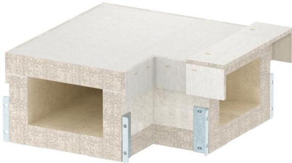
90°-Bogen für Brandschutzkanal PYROLINE® Con S EI90, Typ PLCS D091220 bestehend aus wasser- und frostbeständigem Glasfaserleichtbeton zur Herstellung von horizontalen Richtungsänderungen im Kanalverlauf. Fertig montierte Verbindungsbeschläge sorgen für eine schnelle Montage vor Ort, lose aufgelegte Deckel für eine schnelle Revision und Nachbelegung.
