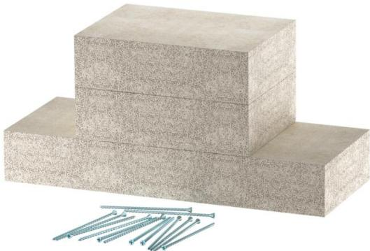
Embase murale pour goulotte coupe-feu PYROLINE® Con D EI90, type PLCD D090810, constituée de béton léger en fibre de verre résistant à l'eau et au gel pour le montage sur la goulotte de protection contre les incendies au niveau des raccords muraux et au plafond et/ou des passages dans les parois et les plafonds. Composé de 3 panneaux individuels (largeur 100 mm, épaisseur 40 mm). Fourni avec vis à tête fraisée.
