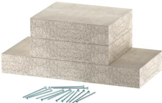
Wandanschlusskragen für Brandschutzkanal PYROLINE® Con D EI60, Typ PLCD D060810 bestehend aus wasser- und frostbeständigem Glasfaserleichtbeton zur Montage auf dem Brandschutzkanal im Bereich von Wand- und Deckenanschlüssen bzw. Wand- und Deckendurchführungen. Bestehend aus 3 Einzelplatten (Breite 100 mm, Dicke 30 mm). Inklusive Senkkopfschrauben. Inklusive Senkkopfschrauben.
