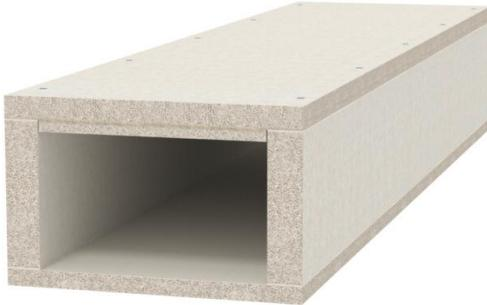
Brandschutzkanal aus wasser- und frostbeständigem Glasfaserleichtbeton der Baustoffklasse A1 gemäß EN 13501-1 zur brandsicheren Verlegung von Kabeln in Flucht- und Rettungswegen. Klassifizierung EI30 - EI60 als Installationskanal gemäß EN 13501-2 auf Basis von Prüfungen gemäß EN 1366-5. Der Kanal verhindert bei einer Brandbelastung von innen (Kabelbrand) die Brandausbreitung von einem Brandabschnitt auf einen anderen.
