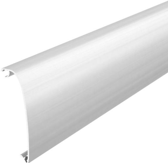
Kanalabdeckung zur Erstellung eines Design-Geräteeinbaukanals der Serie GAD. Designausführung "Soft" zur vollständigen Abdeckung der Systemöffnung und der Schalt- und Steckgeräte. Die Oberteiladapter GAD OTA sind zwingend erforderlich und sollten im max. Abstand von 50 cm auf der Kanalstrecke eingeplant werden. Zwischen den Kanalabdeckungen muss ein Distanzstück GAD OTD gesetzt werden.
