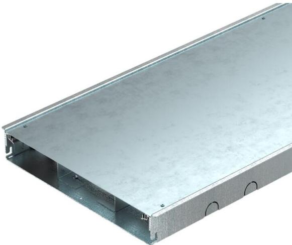
Unità di canale pronta per il montaggio per la posa dei cavi e il montaggio apparecchi composta da una parte inferiore del canale con profilo di posa per rivestimento pavimenti regolabile in altezza. Allo stato di consegna con coperchio di protezione per il montaggio. La fornitura comprende 3 garnizioni giunto coperchio e un connettore canale.
