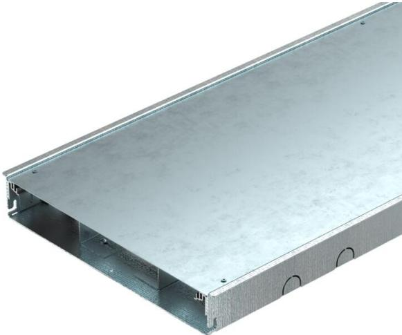
Unité de goulotte prête à monter pour le guidage de câbles et le montage d'appareillages, composée d'un socle de goulotte avec un profilé d'insertion de revêtement de sol réglable en hauteur. Livrée avec couvercle de protection de montage. Trois embouts d'étanchéité de couvercle et un raccord de goulotte sont fournis. Six vis de nivellation sont nécessaires pour le réglage de la hauteur de l'unité de goulotte.
