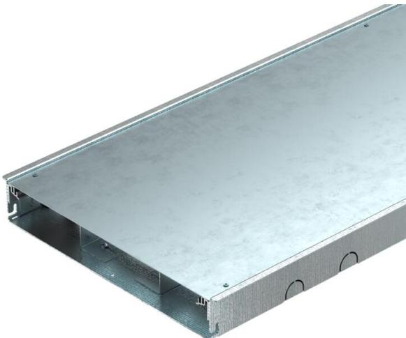
Montagefertige Kanaleinheit zur Leitungsführung und zum Geräteeinbau, bestehend aus einem Kanalunterteil mit höhenverstellbarem Bodenbelag anlegeprofil. Im Auslieferungszustand mit Montageschutzdeckel. Im Lieferumfang enthalten sind 3 Deckelstoßdichtungen und ein Kanalverbinder. Zur Höheneinstellung der Kanaleinheit werden sechs Nivellierschrauben benötigt.
