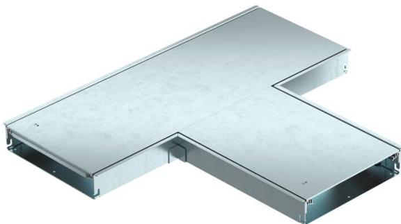
Montagefertiger Kanalabzweig T-STück, bestehend aus Kanalunterteil, zwei Deckeln, höhenverstellbaren Bodenbelaganlegeprofil. Im Lieferumfang enthalten sind zwei Deckelstoßdichtungen und zwei Verbinder. Zur Höheneinstellung werden 6 Nivellierschrauben benötigt.
