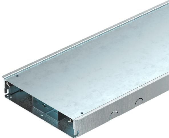
Élément de goulotte prêt à monter pour l'installation de câbles et le montage d'appareillages, composé d'un socle de goulotte avec un profilé d'insertion de revêtement de sol réglable en hauteur. Livré avec couvercle de protection de montage. Trois embouts d'étanchéité de couvercle et un raccord de goulotte sont fournis à la livraison.
