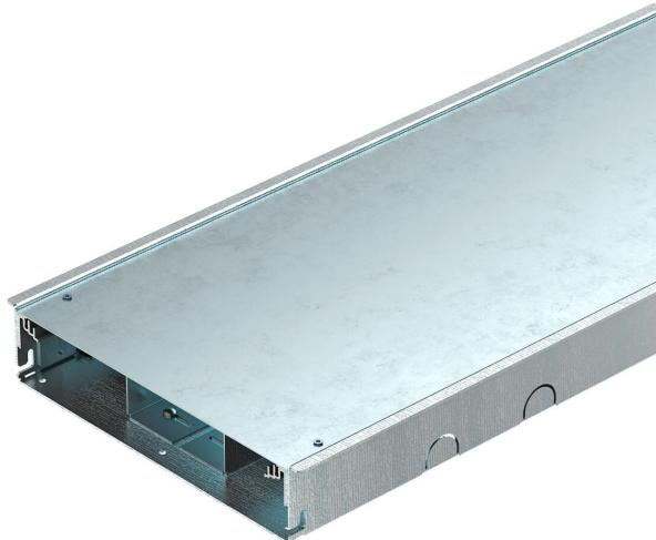
Montagefertige Kanaleinheit zur Leitungsführung und zum Geräteeinbau, bestehend aus einem Kanalunterteil mit höhenverstellbarem Bodenbelag anlegeprofil. Im Auslieferungszustand mit Montageschutzdeckel. Im Lieferumfang enthalten sind 3 Deckelstoßdichtungen und ein Kanalverbinder. Zur Höheneinstellung der Kanaleinheit werden sechs Nivellierschrauben benötigt. Der Nutzbare Kanalquerschnitt beträgt 11765 mm<sup>2</sup>.
