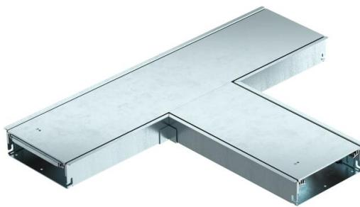
Derivazione del canale del raccordo a T pronta per il montaggio, composta dalla parte inferiore del canale, da due coperchi, profilo d'applicazione rivestimento pavimenti regolabile in altezza. Del volume di fornitura fanno parte due guarnizioni dei giunti del coperchio e due giunti.
