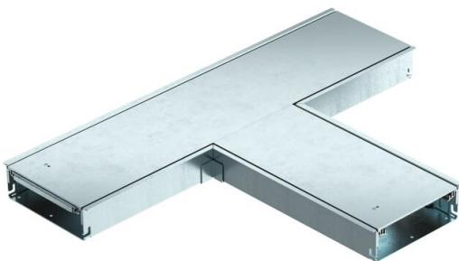
Dérivation de goulotte prête à monter en té, composée d'une base de goulotte, de deux couvercles, d'un profilé d'insertion de revêtement de sol réglable en hauteur. Deux supports de contact d'étanchéité et deux raccords sont fournis à la livraison.
