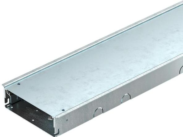
Unità di canale pronta per il montaggio per la posa dei cavi e il montaggio apparecchi composta da una parte inferiore del canale con profilo di posa per rivestimento pavimenti regolabile in altezza. Allo stato di consegna con coperchio di protezione per il montaggio. La fornitura comprende 3 garnizioni giunto coperchio e un connettore canale.
