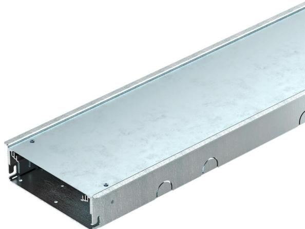
Élément de goulotte prêt à monter pour l'installation de câbles et le montage d'appareillages, composé d'un socle de goulotte avec un profilé d'insertion de revêtement de sol réglable en hauteur. Livré avec couvercle de protection de montage. Trois embouts d'étanchéité de couvercle et un raccord de goulotte sont fournis à la livraison.
