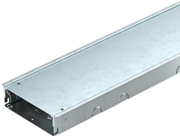
Montagefertige Kanaleinheit zur Leitungsführung und zum Geräteeinbau, bestehend aus einem Kanalunterteil mit höhenverstellbarem Bodenbelag anlegeprofil. Im Auslieferungszustand mit Montageschutzdeckel. Im Lieferumfang enthalten sind 3 Deckelstoßdichtungen und ein Kanalverbinder. Zur Höheneinstellung der Kanaleinheit werden sechs Nivellierschrauben benötigt. Der Nutzbare Kanalquerschnitt beträgt 7395 mm<sup>2</sup>.
