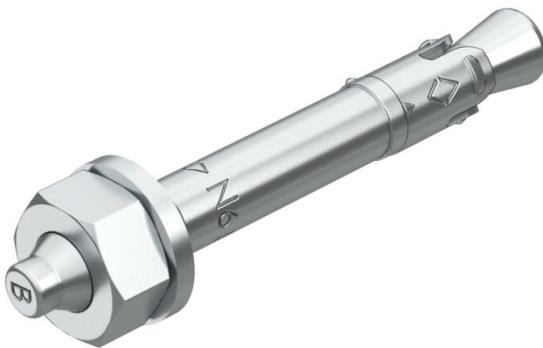
La cheville d'ancrage est utilisable pour des fixations multiples de systèmes non porteurs dans du béton fissuré et non fissuré, il conjugue les avantages d'un boulon d'ancrage et d'une simplicité accrue de montage.
