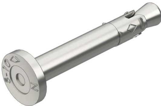
La cheville à colllerette N est utilisable pour des fixations multiples de systèmes non porteurs à l'intérieur et à l'extérieur dans du béton fissuré et non fissuré, elle conjugue les avantages d'un boulon d'ancrage et d'une simplicité accrue de montage.
