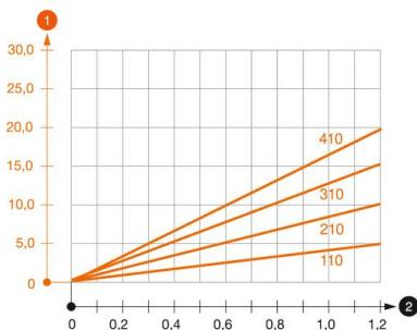
Diagramma di carico mensola tipo MWA 12
