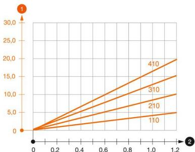
Diagramme de charge de la console type MWAG 12
