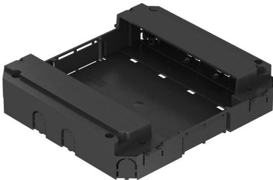
Modulträger für den Einbau von bis zu acht Modul 45-Geräten in einen leeren Standard-Geräteeinsatz oder eine leere nivellierbare Kassette der Nenngröße 9 oder R9. Der Modulträger wird in die Rastleiter eingerastet. Einbaurahmen MT45V für den Einbau der Modul 45-Geräte und die Montageplatten MPMT45 für Datenbuchsen können separat bestellt werden. Die Löcher an der Seitenwand für die Rohreinführung haben einen Durchmesser von 21 mm.
